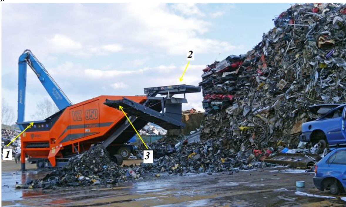
11 Pav. Priešrederio „Titan VZ 950“ darbo proceso vaizdas
