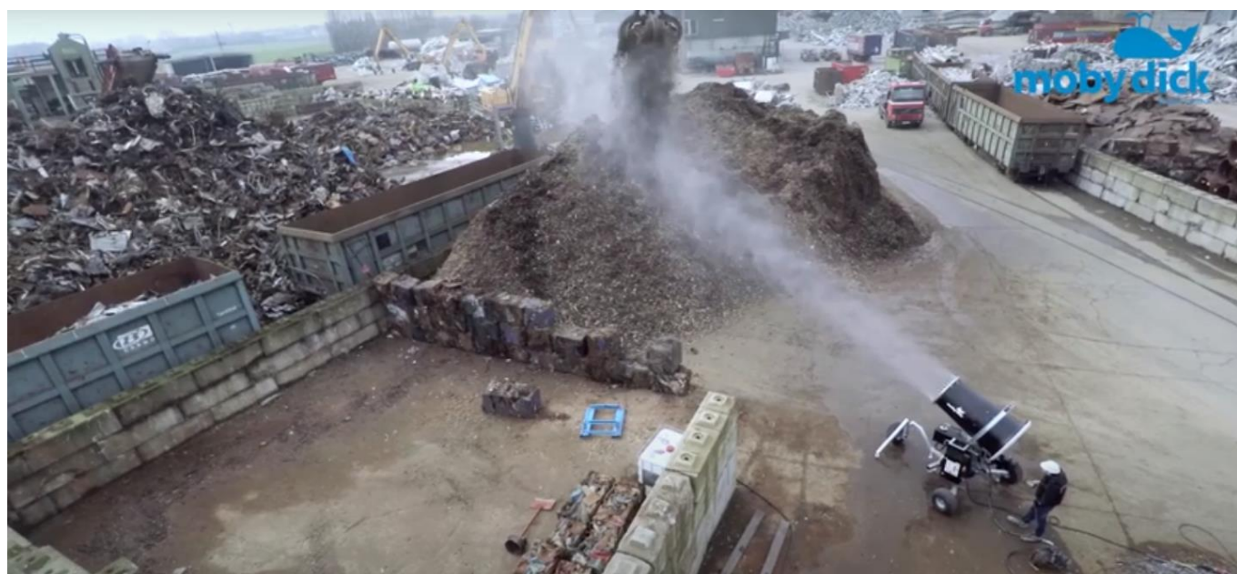
21 Pav. Vandens patrankos naudojimas metalo laužo krovos metu (vandens srovė purškama į metalų laužo iškrovimo ties krano kaušo vietą)
