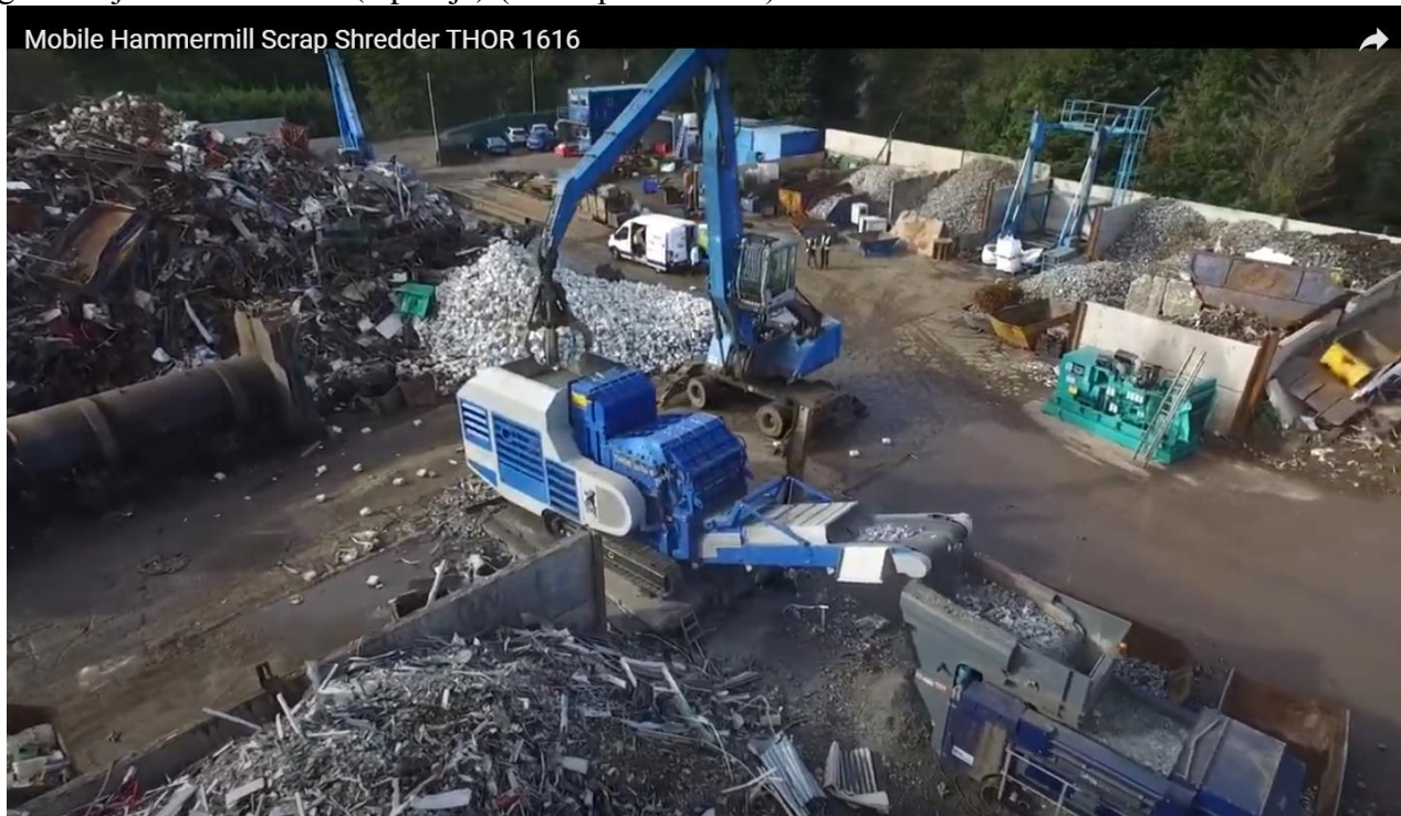
12 Pav. Mobilus smulkintuvas (šrederio) „THOR1616K“ kartu su moduliniais segmentais vaizdas
