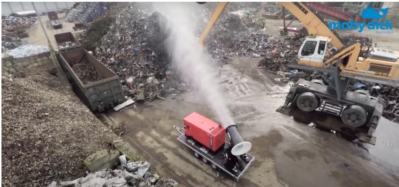
20 Pav. Vandens patrankos naudojimas metalo laužo krovos metu (vandens srovė purškama į metalų laužo kaupą)
