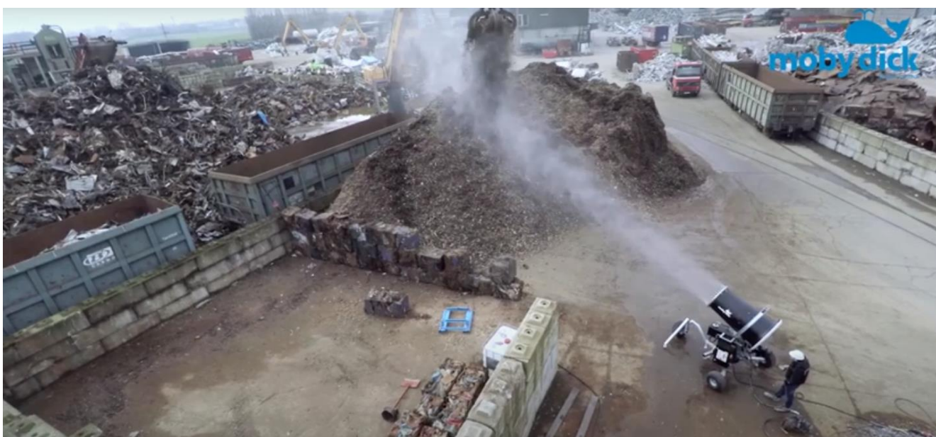
33 Pav. Vandens patrankos naudojimas metalo laužo krovos metu (vandens srovė purškiama į metalų laužo iškrovimo ties krano kaušo vietą)
