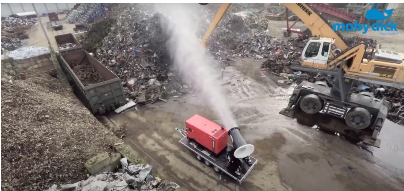
32 Pav. Vandens patrankos naudojimas metalo laužo krovos metu (vandens srovė purškiama į metalų laužo kaupą)
